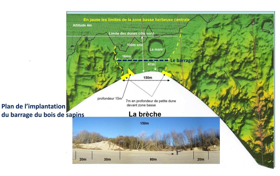
Profil de la brèche du bois de sapins Le barrage est édifié au seuil limite arrière correspondant au niveau de la plage, Le niveau en est ensuite inférieur.
