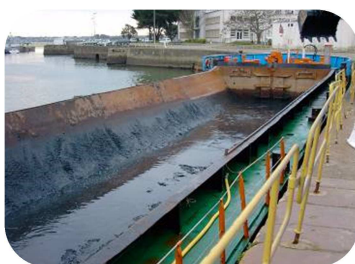
Figure 16 : Chalands autoporteurs utilisables pour le transport des sédiments (Matériel EMCC)
