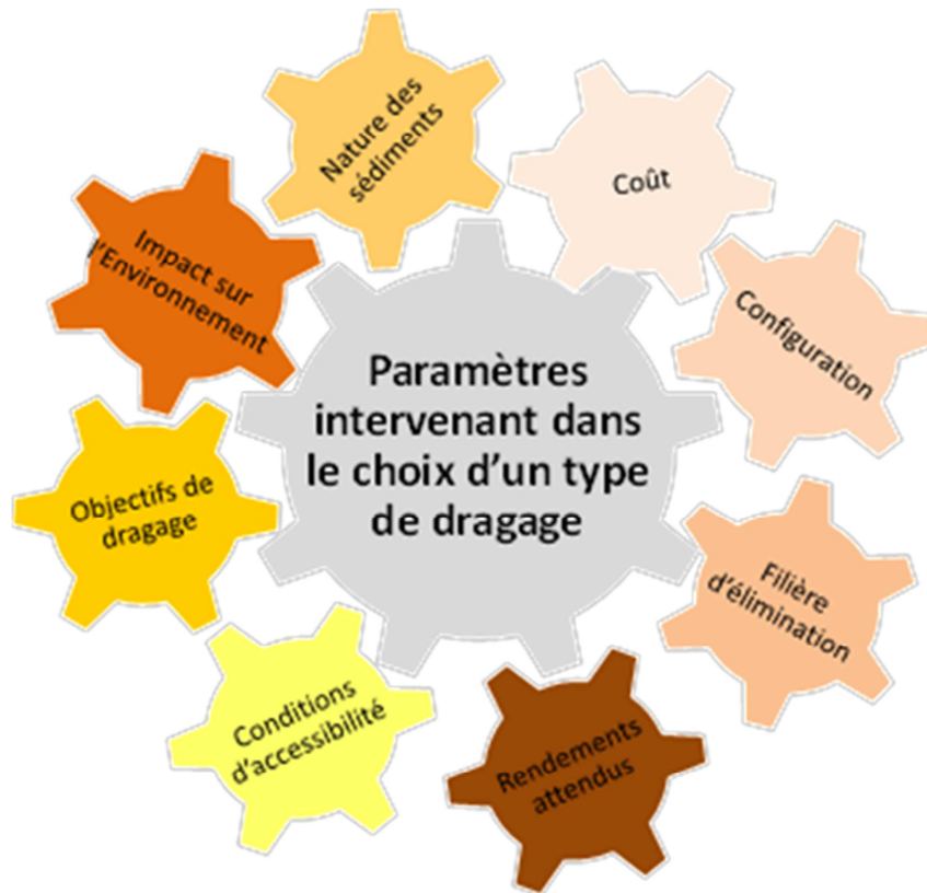
Figure 15 - Paramètres intervenant dans le choix d'un type de dragage
