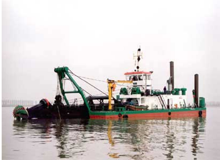
Figure 18 – Dragage aspiratrice stationnaire (Source : IDRA Environnement SAS)
