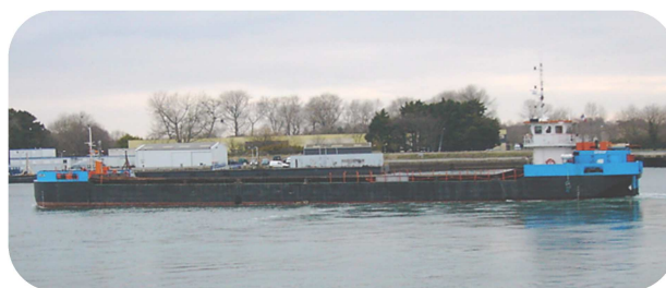
Figure 16 : Chalands autoporteurs utilisables pour le transport des sédiments (Matériel EMCC)
