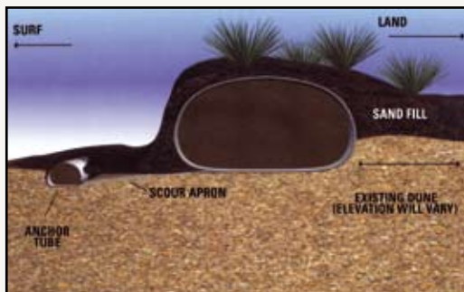
Coupe transversale d'une dune de sable avec un système TenCate Geotube®.
