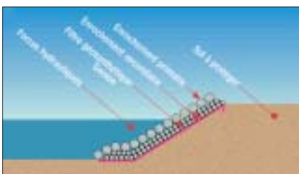
GÉOSYNTHÉTIQUES GEOLON COMME FILTRE POUR LE CONTRÔLE DE L'ÉROSION SOUS REVÊTEMENTS
