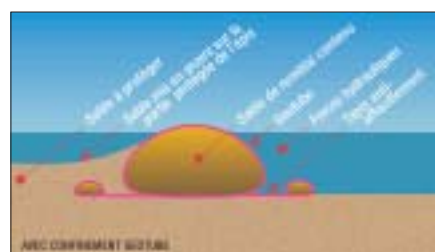
ENROCHEMENTS ET ÉPIS GEOTUBE
