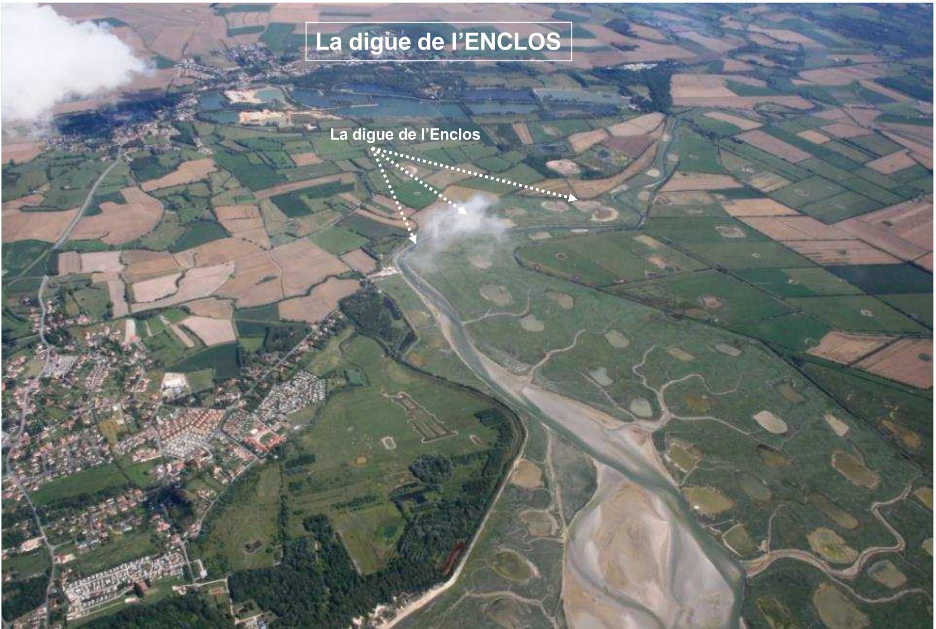
Comme l'écluse de la Madelon, la digue de l'Enclos est située sur le territoire de la commune de Waben. Digue de terre, elle présente aussi une grande importance sur le plan de la protection des zones attenantes contre la submersion et souffre également d'une dégradation globale nécessitant une réfection.
